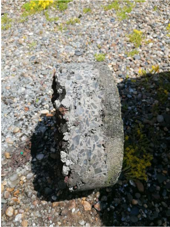
03. Carottage de la dalle du plateau technique
